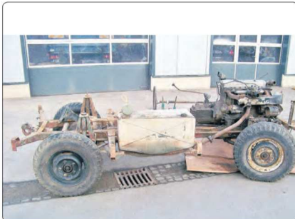
Das Herzstück des Sachsenring P 3. Schwer vorstellbar, dass aus diesem alten, heruntergekommenen Unterbau im Laufe der Monate ein historischer, funktionsfähiger Geländewagen entstehen soll. Doch das Team um Michael Meyer in Schlettau hat es geschafft und das Fahrzeug wieder komplett hergestellt.
